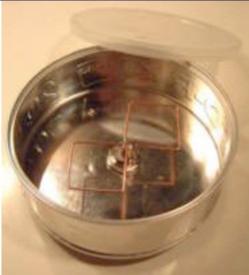
Un bi-quad : antenne directionnelle artisanale, mais redoutablement efficace.
